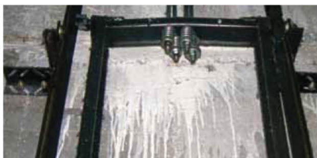
Figura 10 - Telaio del contrappeso piegato Figure 10 - Counterweights frame bent
